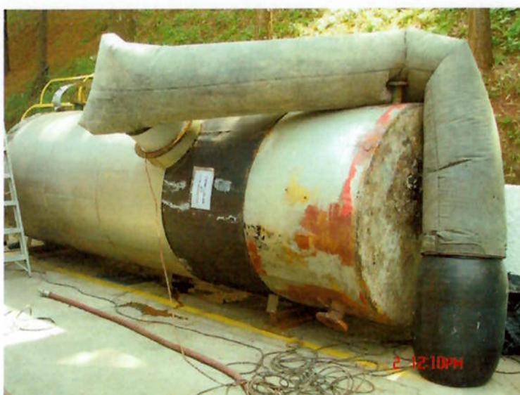
Foto 13. Equipamento de exaustão com coletor para poeira
