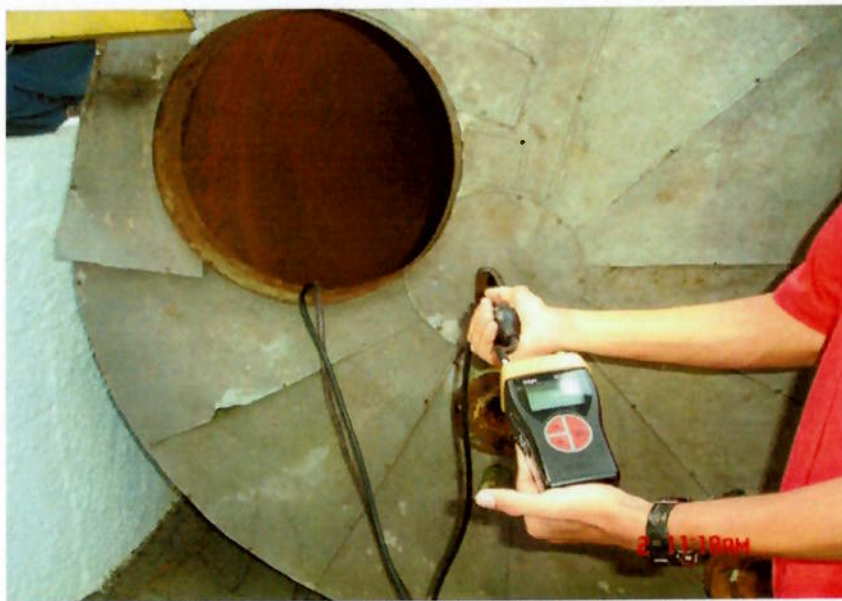
Foto 1. Monitoramento da atmosfera na região central do tanque
